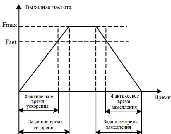
Рис. 6-2 Схема времени ускорения/замедления
