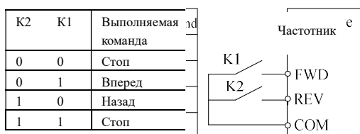
Рис.6-13 Двухпроводной режим управления 1
